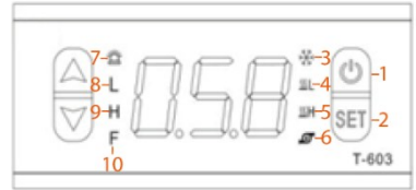
Şekil 12, Soğutma kontrol birimi
